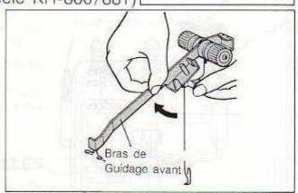
Soulever le bras de guidage avant pour le dégager du système de tension du fil (G).
