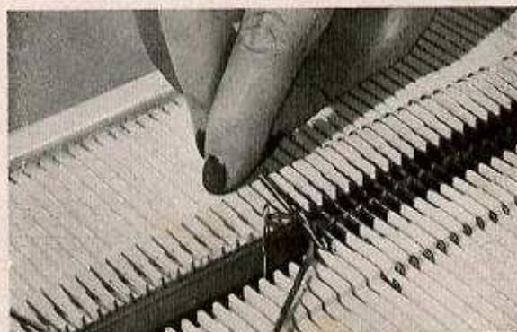
— refermer les fontures et bloquer les boutons de serrage puis engager le chariot du côté où se termine la chaînette.
