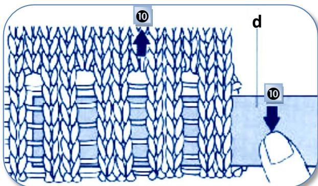
1. Pousser **1 aiguille sur 2** à la position « **B** » pour la largeur du tricot.
