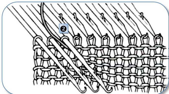
2. Pour éviter qu'un trou ne se forme, passer l'extrémité de la laine **sous** la première aiguille en position « D » et **par-dessus** les autres aiguilles.
