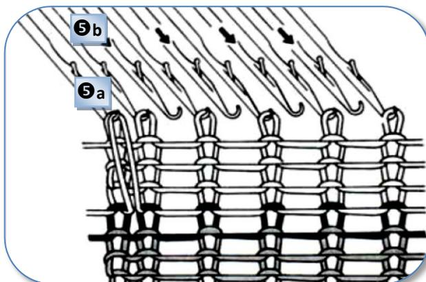
5. Placer la boucle sur l'aiguille d'extrémité.
