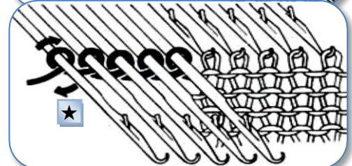
**REMARQUE :** ★ Lorsque le chariot est à gauche, entourer le fil autour des aiguilles dans le sens des aiguilles d'une montre
