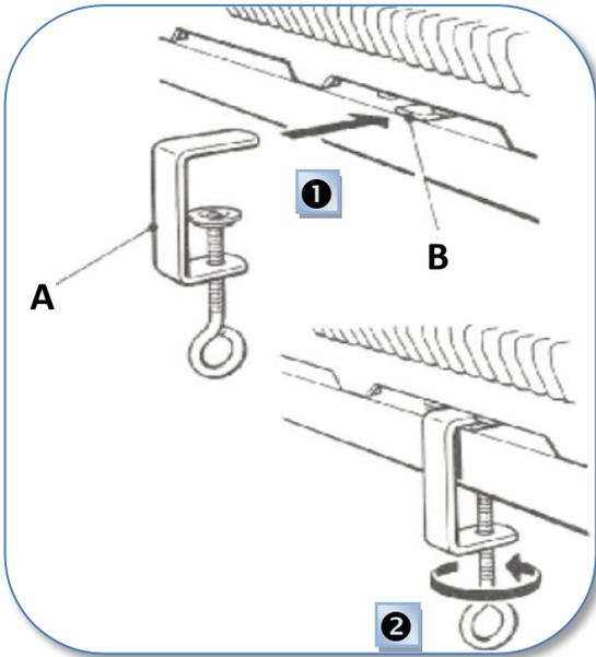
1. Insérer le serre-joint (A) dans la fente (B) au bas et à l'avant de la fonture (voir page 5.)
