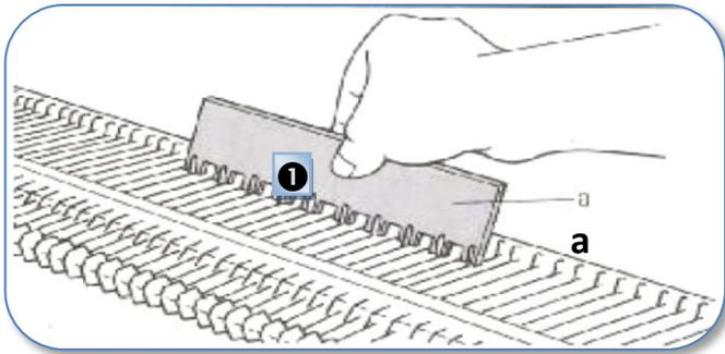
1. A l'aide du bord 1:1 du sélecteur d'aiguilles (a), pousser vers le haut **1 aiguille sur 2** de la position « A » à la position « B » pour la largeur du tricot.
