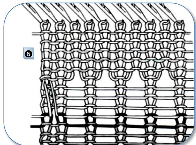
6. Tourner le cadran de densité du point de 2 chiffres plus bas que le tricot en Jersey et
