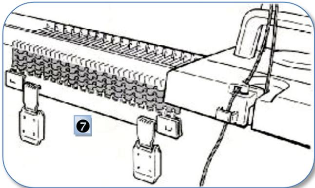
6. Avant de tricoter le deuxième rang, ramener les aiguilles en position « B » vers vous d'environ 5mm (1/4 pouce) à l'aide du sélecteur d'aiguilles et déplacer le chariot sur la fonture.
