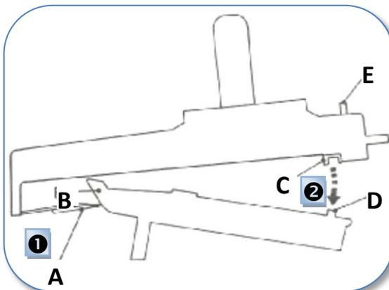
1. Placer d'abord le presseur de tricot (A) sur le bord avant de la fonture,
