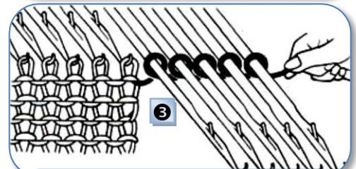
3. Lorsque le chariot est à droite, entourer la laine en "e" sans serrer autour des aiguilles vides dans le sens contraire des aiguilles d'une montre.
