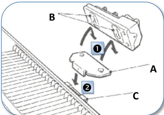
1. Insérer le compteur de rangs en alignant les fentes du compteur (B) sur les montants (A) situées sur le support.
