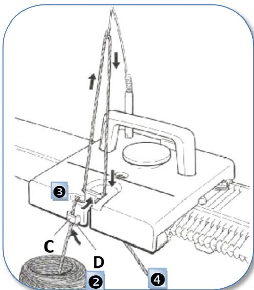
**Insérer l'ensemble de tension dans le chariot**
