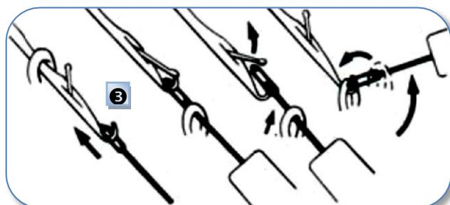
3. À l'aide du poinçon de transfert, repousser les aiguilles qui étaient en position « D » lors du tricot partiel à la position « B »
