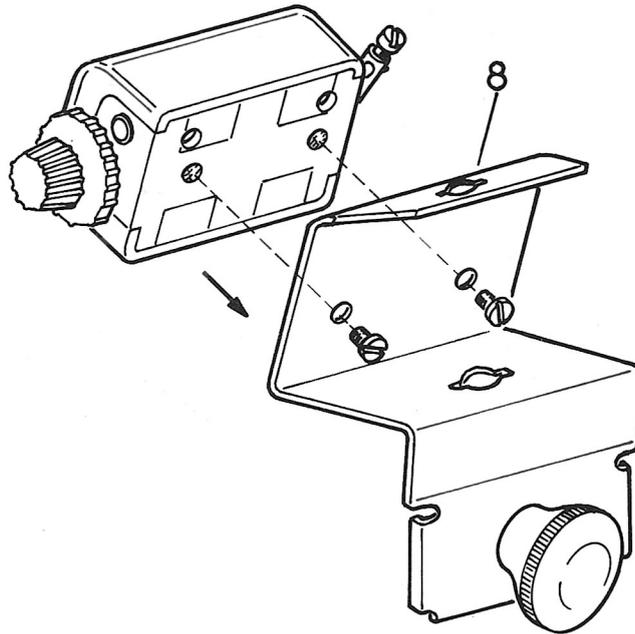
Remontez le compteur de rangs sur le support ⑧ avec le support de l'ordinateur de tricotage ⑨ en utilisant les deux vis de fixation fournies ⑩.
