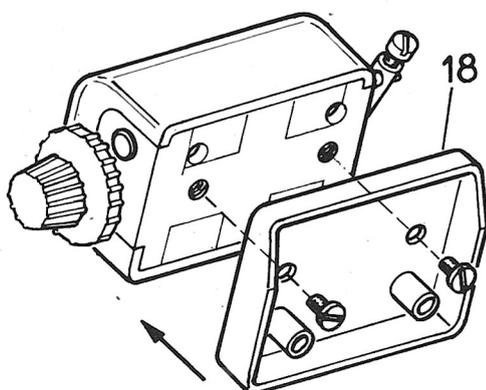
Remontez le compteur sur l'entretoise (18) à l'aide des vis démontées (ce sont les vis les plus courtes).
