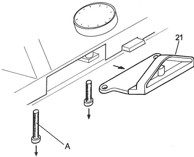
Prenez le chariot de la machine à tricoter et démontez la rampe compteur en métal (21)
