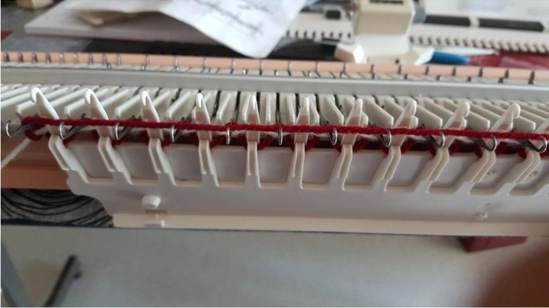
9° Décrochez le peigne \*\* de la rainure . Décrochez le peigne \* des tétons et basculer le en arrière ! accrocher le à la rainure graduée.
