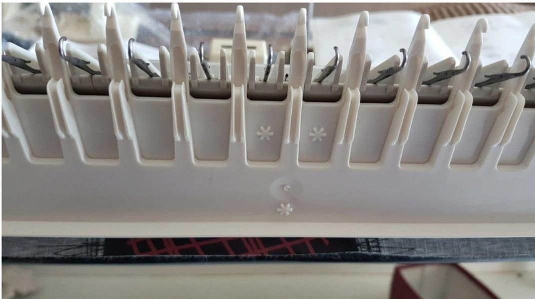
Passer le fil sur l'aiguille , dans l'encoche ( pointe du peigne \* ) , sur l'aiguille etc jusqu'au bout .
