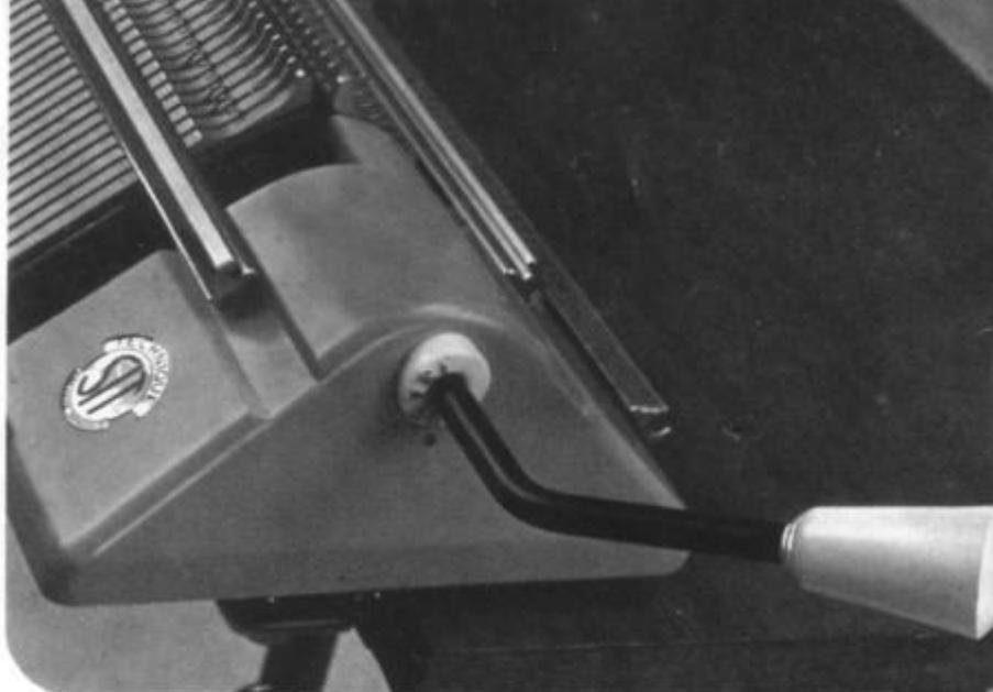
A chaque extrémité des embouts de la machine se trouve un dispositif gradué qui permet d'écarter les fontures de 3 à 6 mm selon l'épaisseur de la laine que l'on désire tricoter. Pour varier l'écartement des deux fontures, introduire dans le dispositif gradué le levier de translation (dans le sens des deux petits traits de repère) et placer le chiffre choisi devant le point de repère rouge, selon le tableau ci-dessous :
