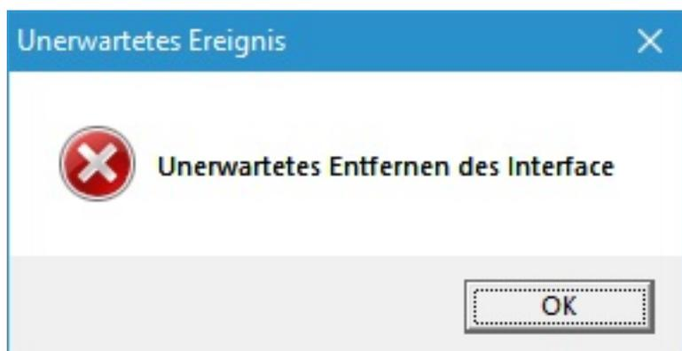
La suppression inattendue est: déconnexion du câble USB de la boîte SuperbaKnit alors que la communication avec celle-ci était en cours. La suppression inattendue peut aussi se produire en cas de réseau USB bruyant ou d'interférence avec d'autres logiciels qui tentent d'accéder au port com virtuel.
