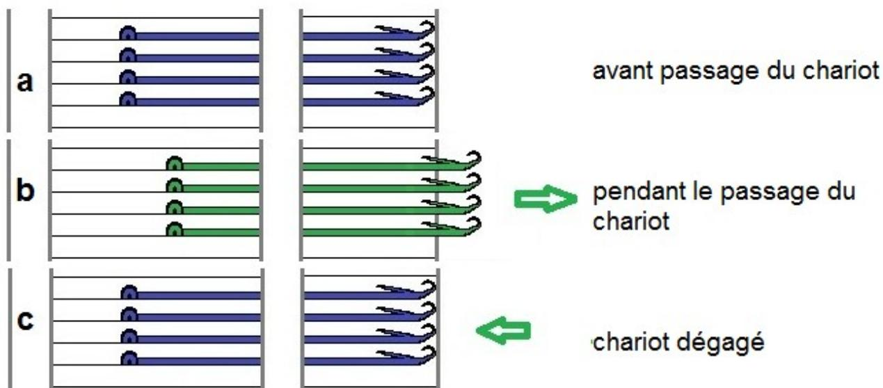
Maintenant : combinez des aiguilles en position travail et des aiguilles en position sélection. Jouez avec les touches et notez ce qui se passe sur chaque groupe d'aiguilles.
